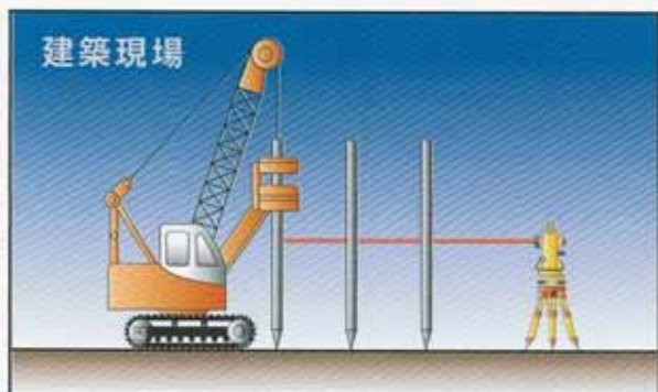
鉄骨位置出し・墨出し・鉛直出し
